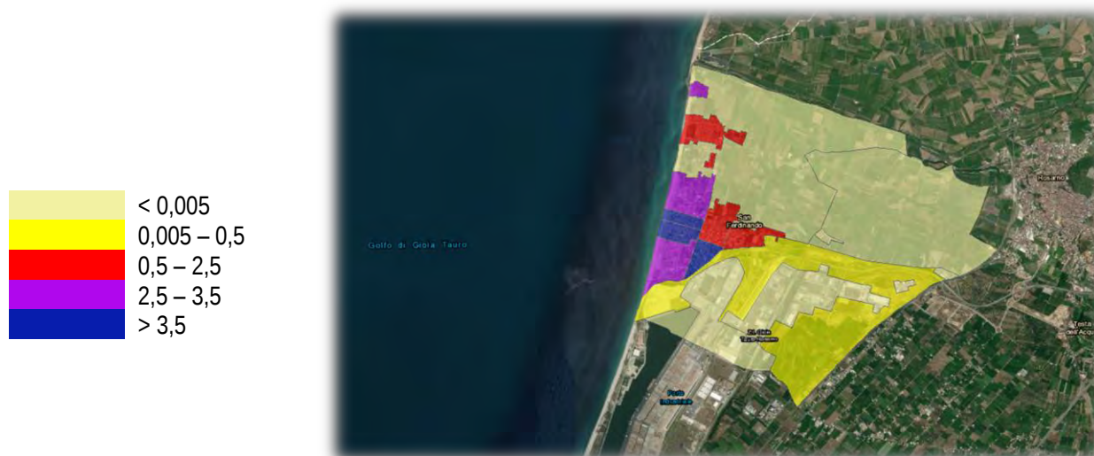
Figura 29. Distribuzione spaziale, per sezione censuaria, dei livelli di danno ( \geq 3 ) attesi su San Ferdinando in caso di sisma di riferimento (Intensità EMS-98 pari a 9)
