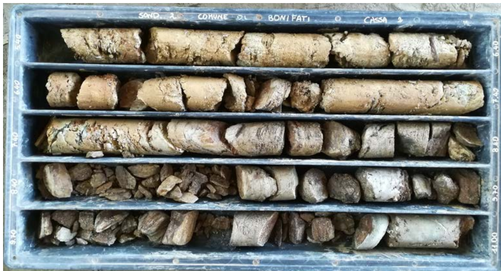
Foto n 6 –Cassetta catalogatrice S2 –C2- materiale carotato da – 5.40 a – 11,00 m dal p.c.
