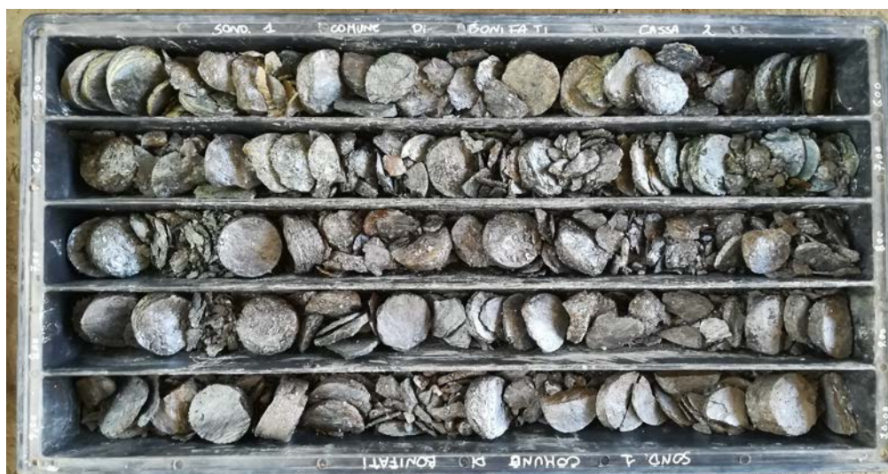
Foto n 10 –Cassetta catalogatrice S1 –C2- materiale carotato da 5.00 a – 10.00 m dal p.c.
