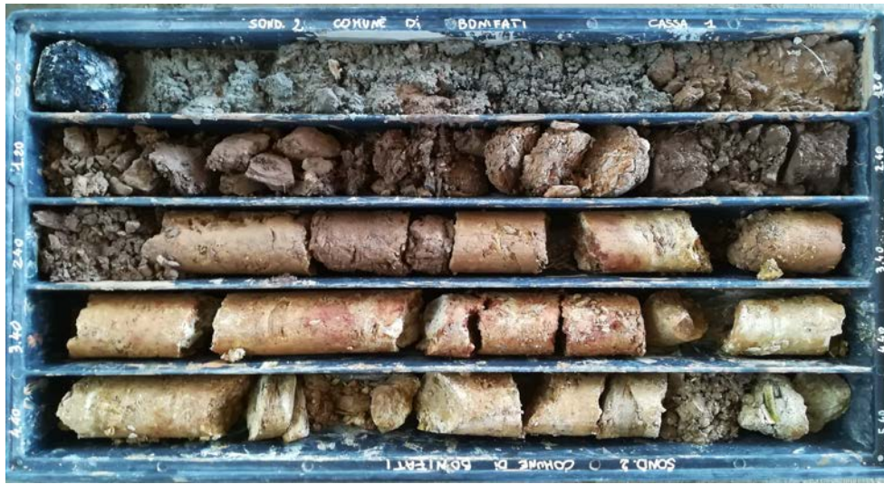
Foto n 5 –Cassetta catalogatrice S2 –C1- materiale carotato da 0.00 a – 5,40 m dal p.c.
