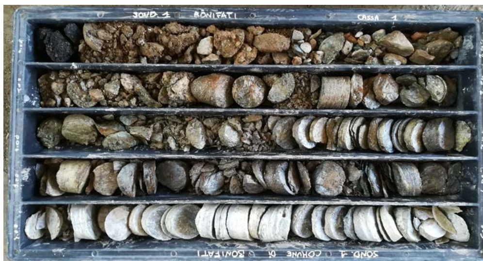
Foto n 9 –Cassetta catalogatrice S1 –C1- materiale carotato da 0.00 a – 5,00 m dal p.c.
